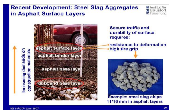
圖4 德國鋼爐渣應用於瀝青混凝土以提昇抗變形能力及增加磨擦力〔4〕
