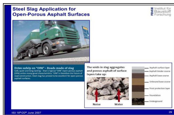
圖5 德國鋼爐渣應用於開放級配磨擦層〔4〕
