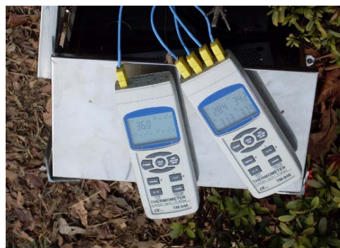
圖 32 鋪面不同深度感溫線量測情形
