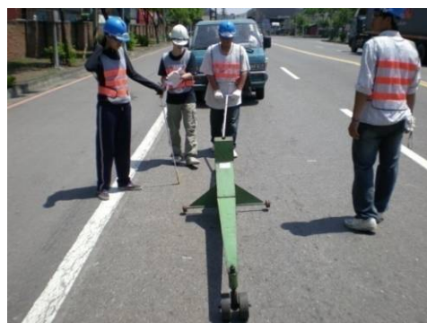
圖 24 平坦度現地試驗過程
