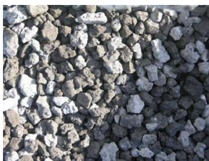
圖 1 轉爐石粒形方正，表面孔隙較多
