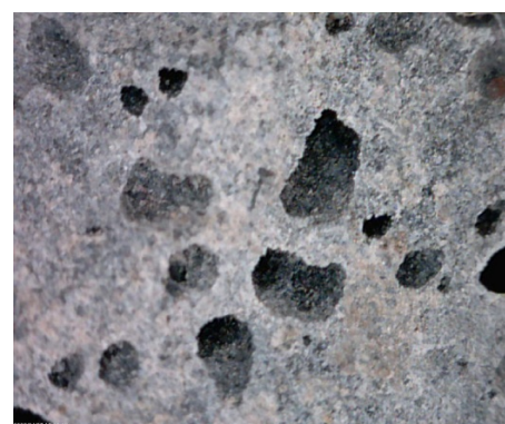
圖 27 轉爐石(粒料表面放大 50 倍)
