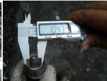
圖61 轉爐石鋪面取樣 圖62 鎢鋼牙刨除定點量測 圖63 刨除定點損耗量測
