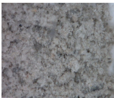
圖 30 天然石(回收粉塵 0.1g) 粒料表面放大 200 倍
