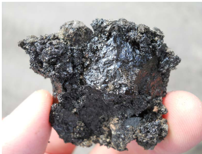
圖64 2007年鋪設轉爐石鋪面之刨除料樣本
