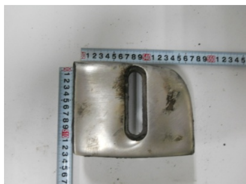
圖44 拌合鼓機組骨手易磨損
