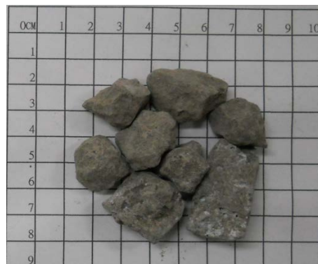
圖 21 轉爐石骨材(六分石 100g)
