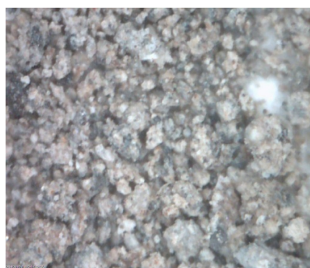
圖 31 轉爐石砂(回收粉塵 0.1g) 粒料表面放大 200 倍
