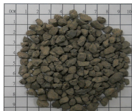
圖 25 轉爐石骨材(二分石 100g)
