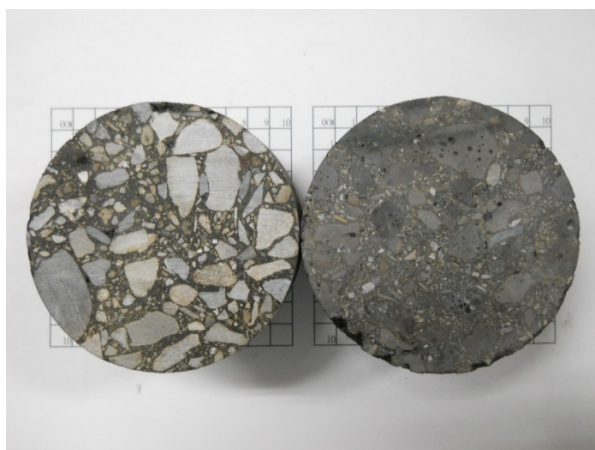
圖58 左.天然石瀝青混凝土(橫剖面) 右.轉爐石瀝青混凝土(橫剖面)
