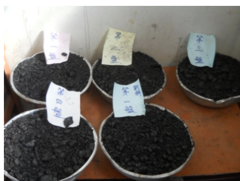
圖47 多次試拌求取最佳拌合時間點
