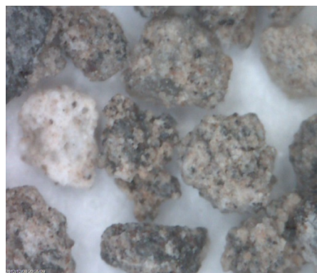
圖 29 轉爐石砂(#100 1g) 粒料表面放大 200 倍
