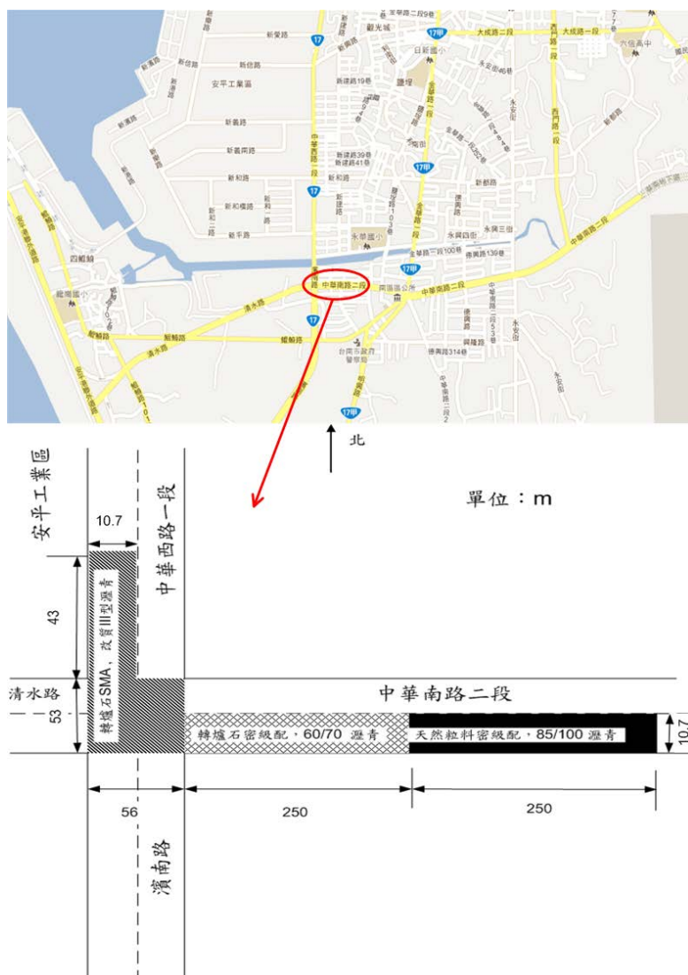
圖 2 示範道路鋪設地點與材料示意圖
