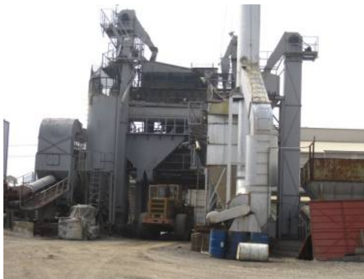
圖 12 1.5 噸盤式瀝青拌和廠
