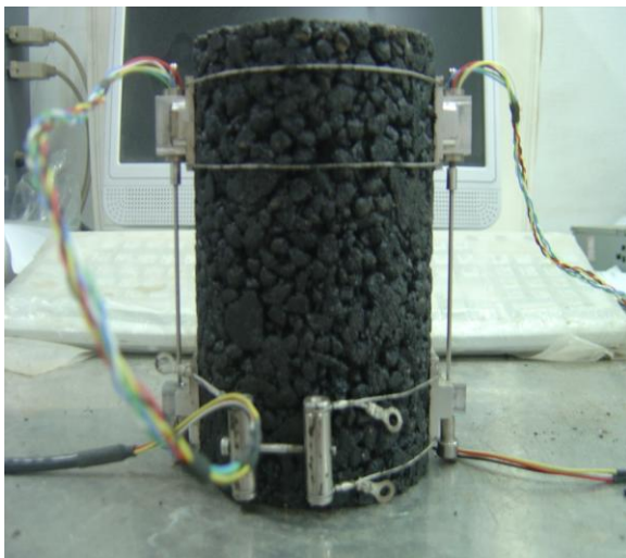
圖 2(a)動態模數試體所使用 LVDT 架構
